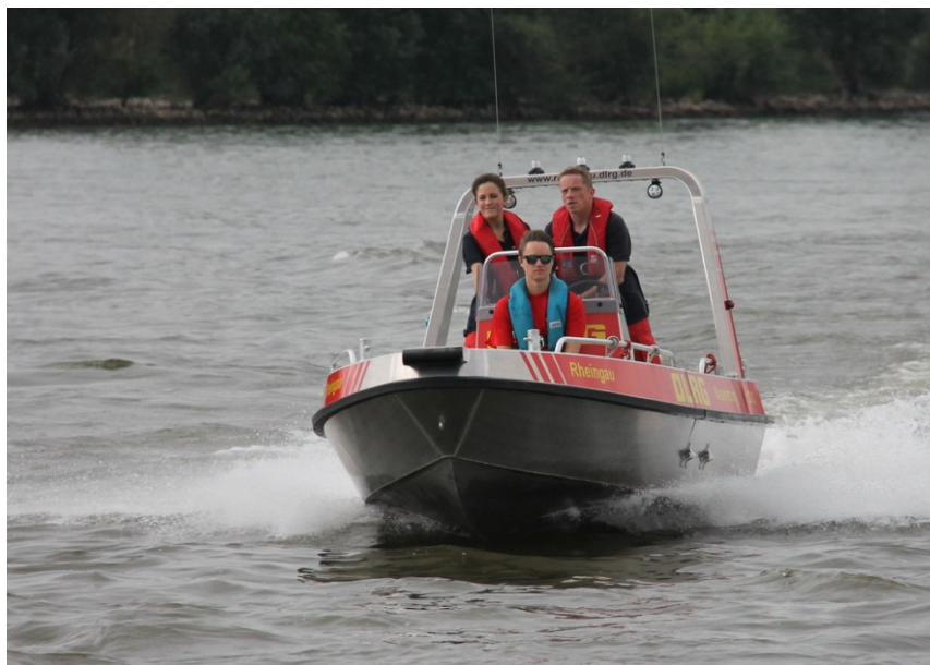
Hervorragend Fahrstabilität und Rauwassereigenschaften durch den V-Kiel
