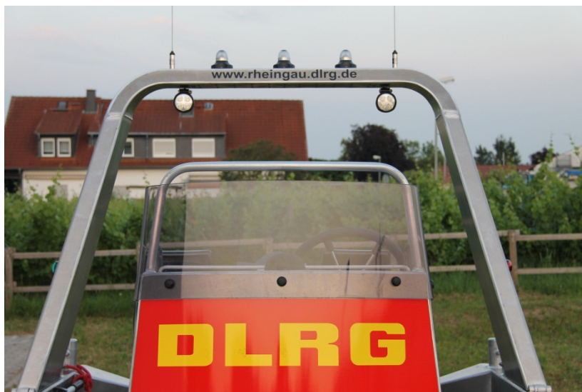
Der Gerätebügel mit Arbeitsscheinwerfern, Seitenlichter, Topplicht, blaues Funklicht (sämtliche Lichter als LED) sowie die Antennen für Binnenschiffahrtfunk und DLRG-Betriebsfunk
