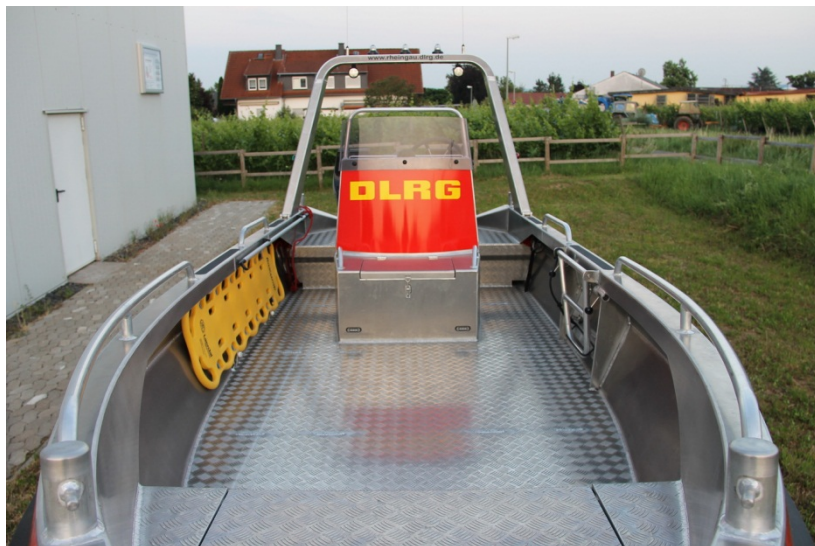
Innenansicht mit Mittelsteuerstand und Gerätebügel Steuerbord: Spineboard / Backbord: Seitenklappe
