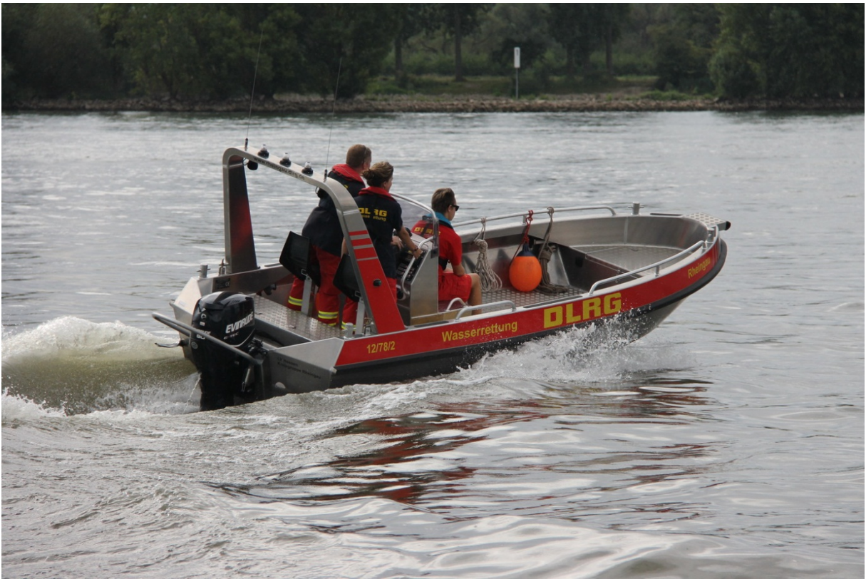
Selbstlenzender Innenbereich – eine Bilgenpumpe ist überflüssig!
