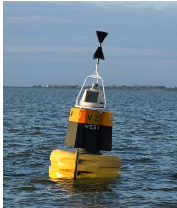
Gefahrenstellentonne westlich der Gefahrenstelle
