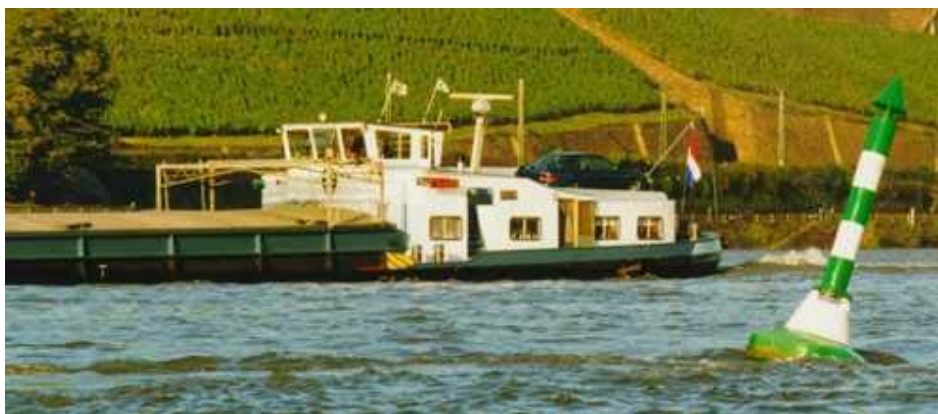
Hindernis linke Fahrwasserseite
