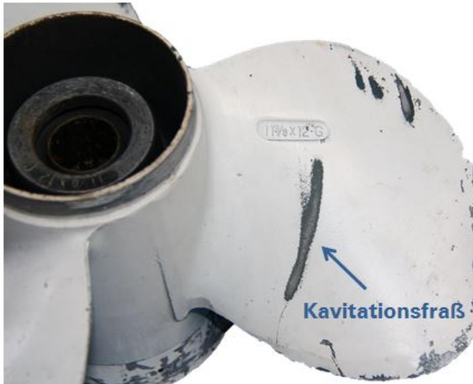
Leichte Kavitationsschäden an einem Propeller
