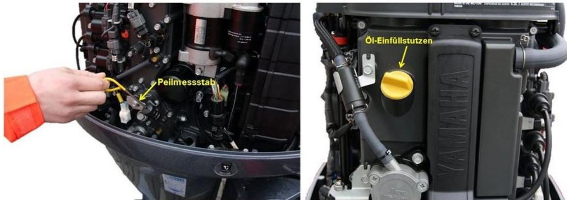
Peilmesstab und Nachfüllstutzen am 4-Takt-Motor
