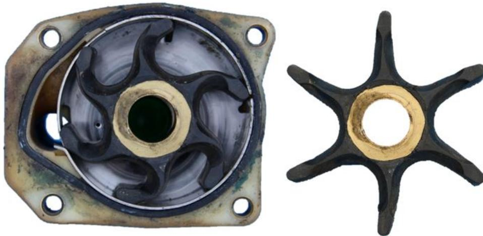
Impeller mit und ohne Wasserpumpen-Gehäuse
