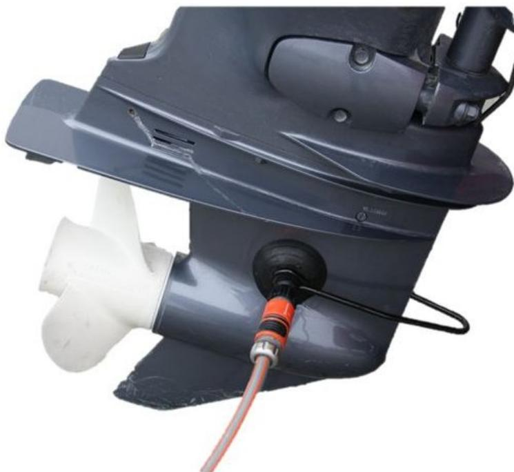
Kühlwasserzufuhr über einen Spülanschluß
