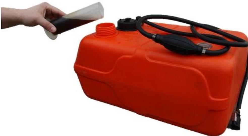
Manuelle Beimischung von 2-Takt-Schmieröl in den Kraftstoff
